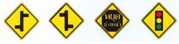
2-22 เครื่องหมายเตือนทางแยก 2-23 เครื่องหมายเตือนทางแยก 2-24 หยุดข้างหน้า 2-25 สัญญาณไฟ
